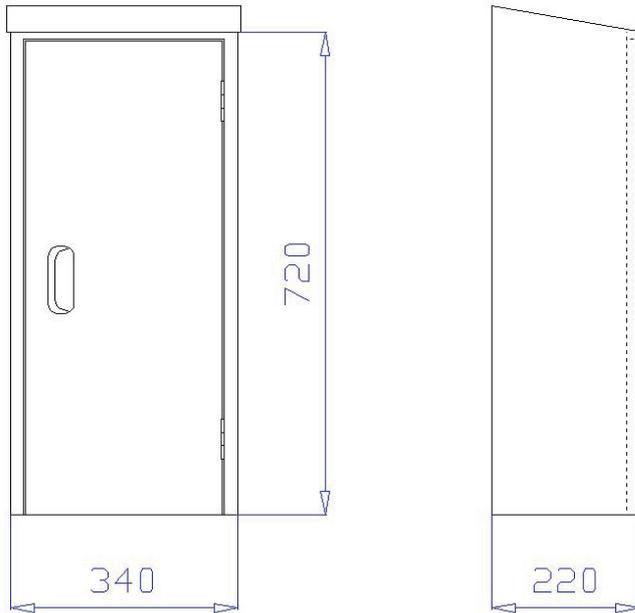
Aufputzschrank Bauart C 340 x 720 x 220 mm (Breite x Höhe x Tiefe) mit schrägem Dach, an drei Seiten überstehend, zur Aufnahme eines 6-kg- oder 12-kg-Handfeuerlöschers. Aus 1 mm verzinktem Stahlblech gekantet und verschweißt, frontseitige Stöße verschweißt und verschliffen. Belüftung über Türspalt. Montagebohrungen in der Rückwand. Endlackiert in Rot (RAL 3001).
