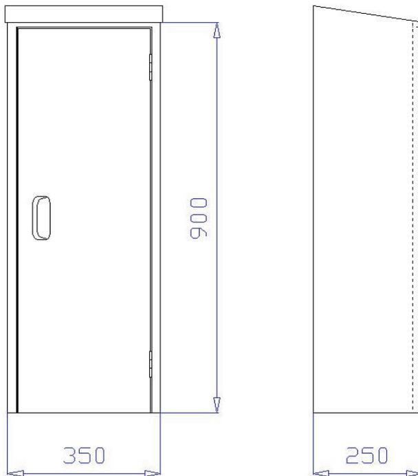
Aufputzschrank Bauart C 350 x 900 x 250 mm (Breite x Höhe x Tiefe) mit schrägem Dach, an drei Seiten überstehend, zur Aufnahme eines 6-kg-CO<sub>2</sub>-Handfeuerlöschers. Aus 1 mm verzinktem Stahlblech gekantet und verschweißt, frontseitige Stöße verschweißt und verschliffen. Belüftung über Türspalt. Montagebohrungen in der Rückwand. Endlackiert in Rot (RAL 3001).
