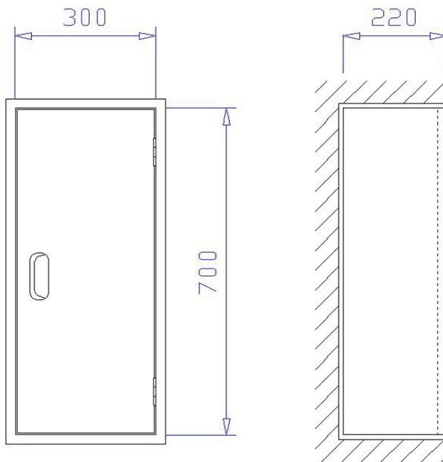
Unterputzschrank Bauart B 300 x 700 x 220 mm, für Nische 320 x 720 x 230 mm (Breite x Höhe x Tiefe), zur Aufnahme eines 12-kg-Handfeuerlöschers. Aus 1 mm verzinktem Stahlblech gekantet und verschweißt, mit Putzleiste aus Winkeleisen 20 x 20 x 3 mm, frontseitige Stöße verschweißt und verschliffen. Belüftung über Türspalt. Montagebohrungen in der Rückwand. Endlackiert in Rot (RAL 3001).
