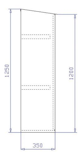
Aufputzschrank 700 x 1200/1250 x 350 mm (Breite x Höhe x Tiefe) mit schrägem Dach, an drei Seiten überstehend. Schrank aus 1 mm verzinktem Stahlblech gekantet und verschweißt. Belüftung über Türspalt. An der Rückwand Halter für Unterflurhydrantenschlüssel und zwei Dorne zur Aufnahme von je 3 Längen C-Schlauch oder 2 Längen B-Schlauch. An der Seitenwand Halter für ein Standrohr und zwei Strahlrohre. Schrank endlackiert in Rot (RAL 3001).
