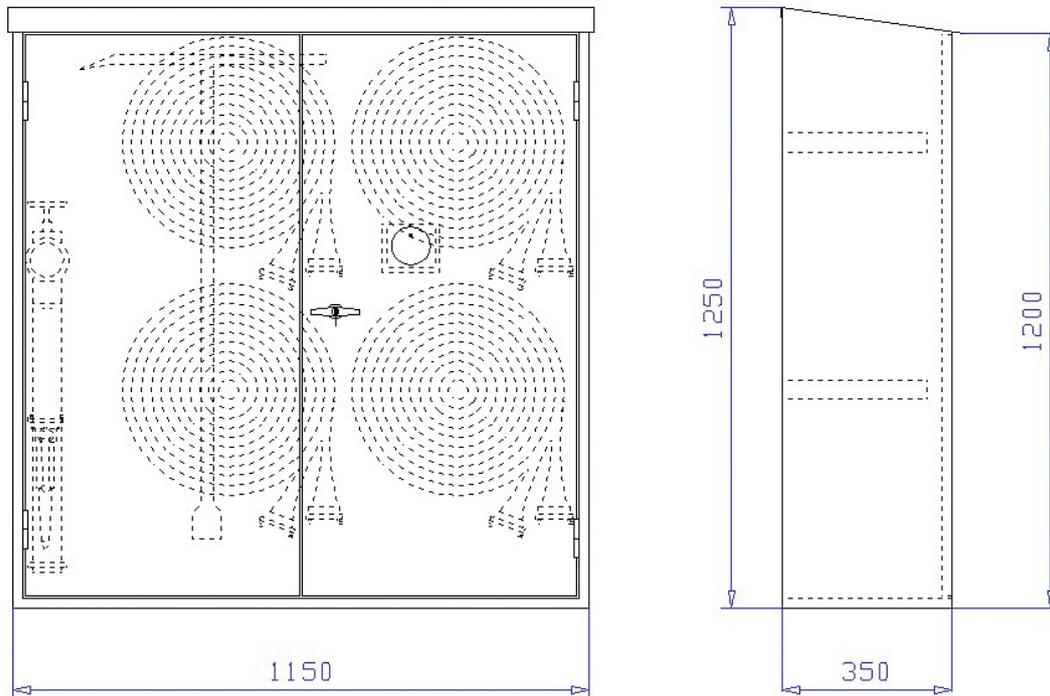
Aufputzschrank 1150 x 1200/1250 x 350 mm (Breite x Höhe x Tiefe) mit schrägem Dach, an drei Seiten überstehend. Schrank aus 1 mm verzinktem Stahlblech gekantet und verschweißt. Belüftung über Türspalt. An der Rückwand Halter für Unterflurhydrantenschlüssel und vier Dorne zur Aufnahme von je 3 Längen C-Schlauch oder 2 Längen B-Schlauch. An der Seitenwand Halter für ein Standrohr und zwei Strahlrohre. Schrank endlackiert in Rot (RAL 3001).
