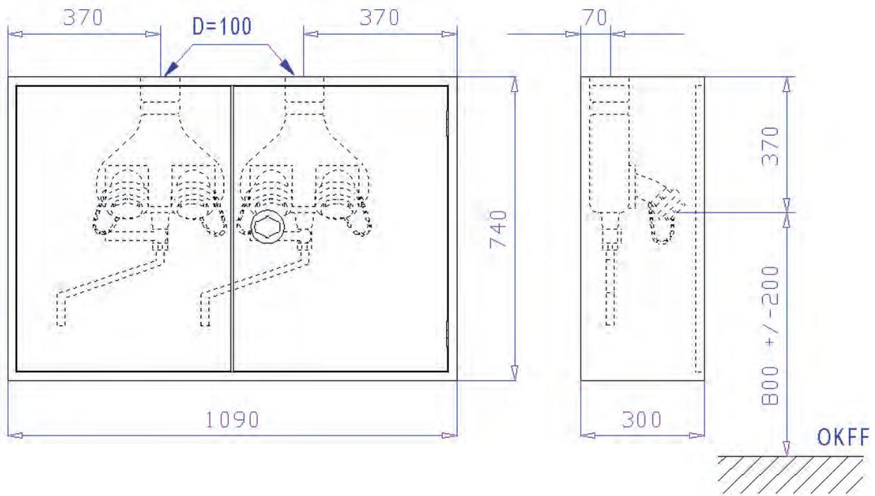
Aufputzschrank Bauart C 1090 x 740 x 300 mm (Breite x Höhe x Tiefe) nach DIN 14461-2. Aus 1 mm verzinktem Stahlblech gekantet und verschweißt, frontseitige Stöße verschweißt und verschliffen. Belüftung über Türspalt. Vier Montagebohrungen in der Rückwand. Wasseranschluss  $\varnothing$  100 mm mittig im Dach, 70 mm mittig von hinten, wie abgebildet, auf Wunsch auch andere Positionen. Endlackiert in Rot (RAL 3001).
