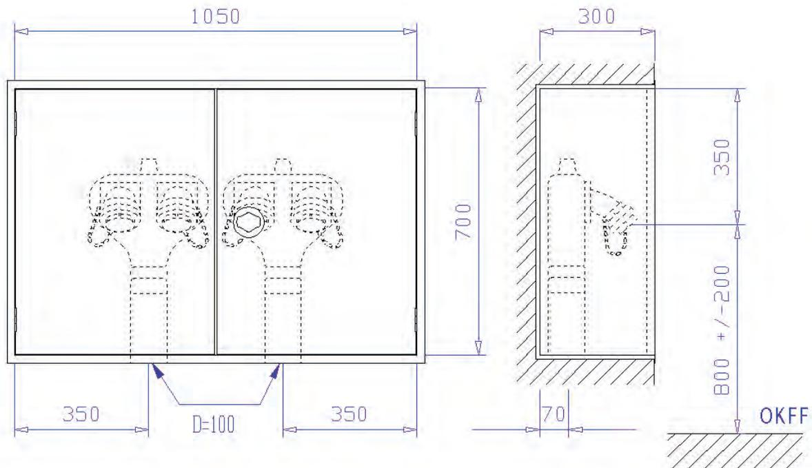
Unterputzschrank Bauart B 1050 x 700 x 300 mm, für Nische 1070 x 720 x 310 mm (Breite x Höhe x Tiefe) nach DIN 14461-2. Aus 1 mm verzinktem Stahlblech gekantet und verschweißt, mit Putzleiste aus Winkeleisen 25 x 25 x 3 mm, frontseitige Stöße verschweißt und verschliffen. Belüftung über Türspalt. Vier Montagebohrungen in der Rückwand. Wasseranschluss  $\varnothing$  100 mm mittig im Boden, 70 mm von hinten, wie abgebildet, auf Wunsch auch andere Positionen. Endlackiert in Rot (RAL 3001).
