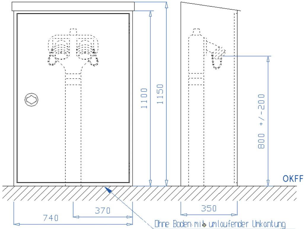
Aufputzschrank Bauart C 740 x 1150 x 350 mm (Breite x Höhe x Tiefe) nach DIN 14461-2. Aus 1 mm Edelstahl 1.4301 geschliffen Korn 240 gekantet und verschweißt, frontseitige Stöße verschweißt und verschliffen. Belüftung über Türspalt. Vier Montagebohrungen in der Rückwand. Wasseranschluss  $\varnothing$  100 mm mittig im Dach, 70 mm von hinten, wie abgebildet, auf Wunsch auch andere Positionen.
