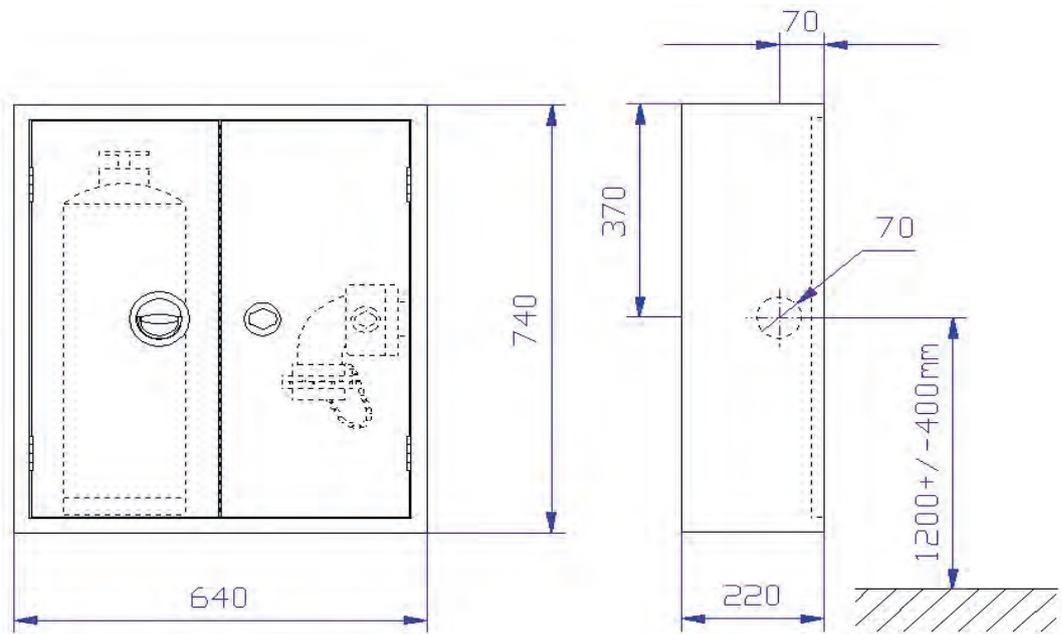
Aufputzschrank Bauart C 640 x 740 x 220 mm (Breite x Höhe x Tiefe) nach DIN 14461-2. Aus 1 mm verzinktem Stahlblech gekantet und verschweißt, frontseitige Stöße verschweißt und verschliffen. Belüftung über Türspalt. Vier Montagebohrungen in der Rückwand.
