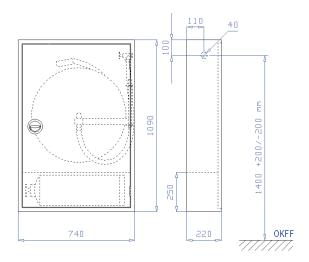
Aufputzschrank Bauart C 740 x 1090 x 220 mm (Breite x Höhe x Tiefe) nach DIN 14461-1. Aus 1 mm verzinktem Stahlblech gekantet und verschweißt, frontseitige Stöße verschweißt und verschliffen. Belüftung über Türspalt. Vier Montagebohrungen in der Rückwand.
