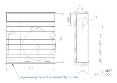
Unterputzschrank Bauart B 960 x 960 x 220 mm, für Nische 980 x 980 x 230 mm (Breite x Höhe x Tiefe) nach DIN 14461-1. Aus 1 mm verzinktem Stahlblech gekantet und verschweißt, mit Putzleiste aus Winkeleisen 25 x 25 x 3 mm, frontseitige Stöße verschweißt und verschliffen. Belüftung über Türspalt. Vier Montagebohrungen in der Rückwand.
