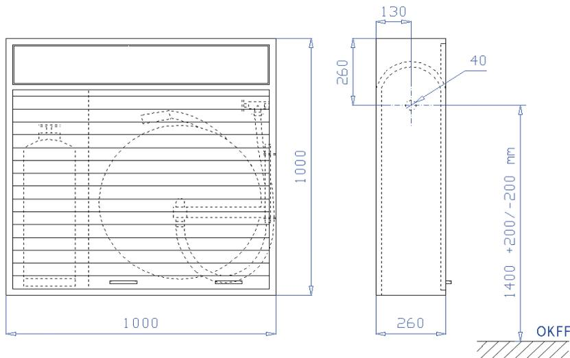
Aufputzschrank Bauart C 1000 x 1000 x 260 mm (Breite x Höhe x Tiefe) nach DIN 14461-1. Aus 1 mm verzinktem Stahlblech gekantet und verschweißt, frontseitige Stöße verschweißt und verschliffen. Belüftung über Türspalt. Vier Montagebohrungen in der Rückwand.
