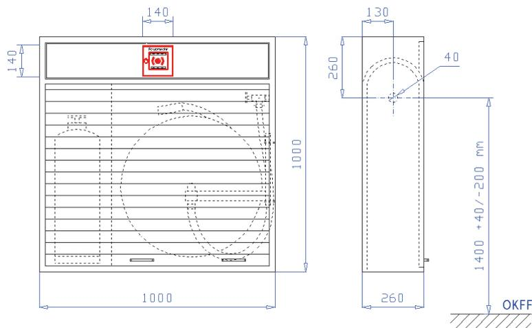
Aufputzschrank Bauart C 1000 x 1000 x 260 mm (Breite x Höhe x Tiefe) nach DIN 14461-1. Aus 1 mm verzinktem Stahlblech gekantet und verschweißt, frontseitige Stöße verschweißt und verschliffen. Belüftung über Türspalt. Vier Montagebohrungen in der Rückwand.
