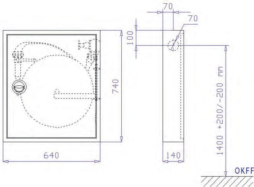
Aufputzschrank Bauart C 640 x 740 x 140 mm (Breite x Höhe x Tiefe) nach DIN 14461-1. Aus 1 mm verzinktem Stahlblech gekantet und verschweißt, frontseitige Stöße verschweißt und verschliffen. Belüftung über Türspalt. Vier Montagebohrungen in der Rückwand.
