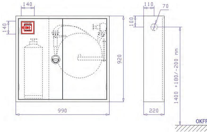
Aufputzschrank Bauart C 990 x 920 x 220 mm (Breite x Höhe x Tiefe) nach DIN 14461-1. Aus 1 mm verzinktem Stahlblech gekantet und verschweißt, frontseitige Stöße verschweißt und verschliffen. Belüftung über Türspalt. Vier Montagebohrungen in der Rückwand.
