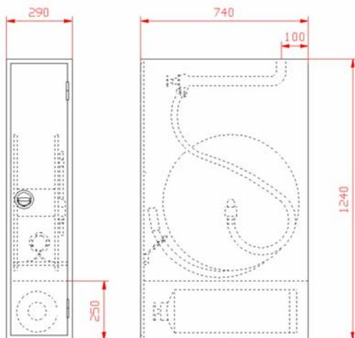
Aufputzschrank Bauart C 290 x 1240 x 740 mm (Breite x Höhe x Tiefe) ähnlich DIN 14461-1. Aus 1 mm verzinktem Stahlblech gekantet und verschweißt, frontseitige Stöße verschweißt und verschliffen. Belüftung über Türspalt. Vier Montagebohrungen in der Rückwand.
