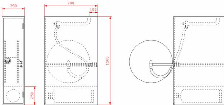
Aufputzschrank Bauart C 390 x 1500 x 700 mm (Breite x Höhe x Tiefe) ähnlich DIN 14461-1. Aus 1 mm verzinktem Stahlblech gekantet und verschweißt, frontseitige Stöße verschweißt und verschliffen. Belüftung über Türspalt. Vier Montagebohrungen in der Rückwand.
