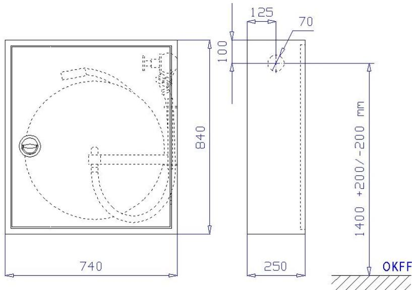
Aufputzschrank Bauart C 740 x 840 x 250 mm (Breite x Höhe x Tiefe) nach DIN 14461-1. Aus 1 mm verzinktem Stahlblech gekantet und verschweißt, frontseitige Stöße verschweißt und verschliffen. Belüftung über Türspalt. Vier Montagebohrungen in der Rückwand.
