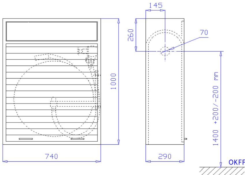
Aufputzschrank Bauart C 740 x 1000 x 290 mm (Breite x Höhe x Tiefe) nach DIN 14461-1. Aus 1 mm verzinktem Stahlblech gekantet und verschweißt, frontseitige Stöße verschweißt und verschliffen. Belüftung über Türspalt. Vier Montagebohrungen in der Rückwand.
