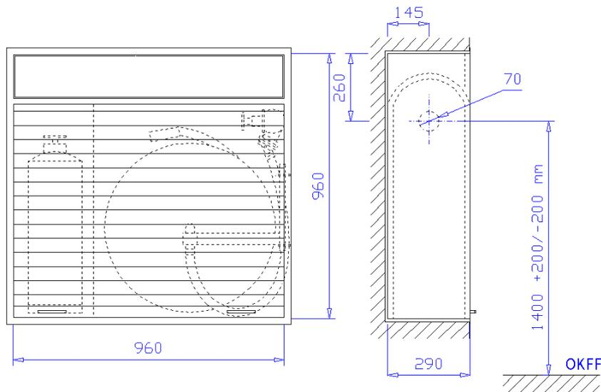
Unterputzschrank Bauart B 960 x 960 x 290 mm, für Nische 980 x 980 x 300 mm (Breite x Höhe x Tiefe) nach DIN 14461-1. Aus 1 mm verzinktem Stahlblech gekantet und verschweißt, mit Putzleiste aus Winkeleisen 25 x 25 x 3 mm, frontseitige Stöße verschweißt und verschliffen. Belüftung über Türspalt. Vier Montagebohrungen in der Rückwand.
