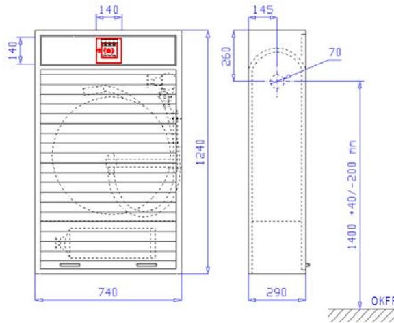
Aufputzschrank Bauart C 740 x 1240 x 290 mm (Breite x Höhe x Tiefe) nach DIN 14461-1. Aus 1 mm verzinktem Stahlblech gekantet und verschweißt, frontseitige Stöße verschweißt und verschliffen. Belüftung über Türspalt. Vier Montagebohrungen in der Rückwand.
