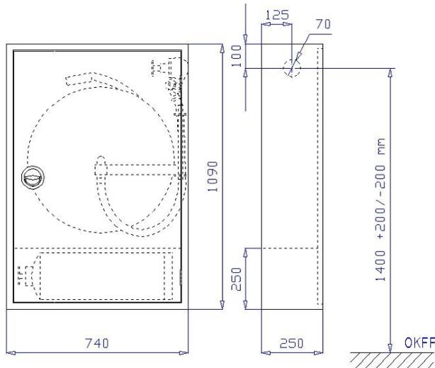
Aufputzschrank Bauart C 740 x 1090 x 250 mm (Breite x Höhe x Tiefe) nach DIN 14461-1. Aus 1 mm verzinktem Stahlblech gekantet und verschweißt, frontseitige Stöße verschweißt und verschliffen. Belüftung über Türspalt. Vier Montagebohrungen in der Rückwand.
