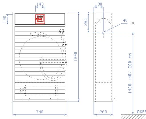
Aufputzschrank Bauart C 740 x 1240 x 260 mm (Breite x Höhe x Tiefe) nach DIN 14461-1. Aus 1 mm verzinktem Stahlblech gekantet und verschweißt, frontseitige Stöße verschweißt und verschliffen. Belüftung über Türspalt. Vier Montagebohrungen in der Rückwand.
